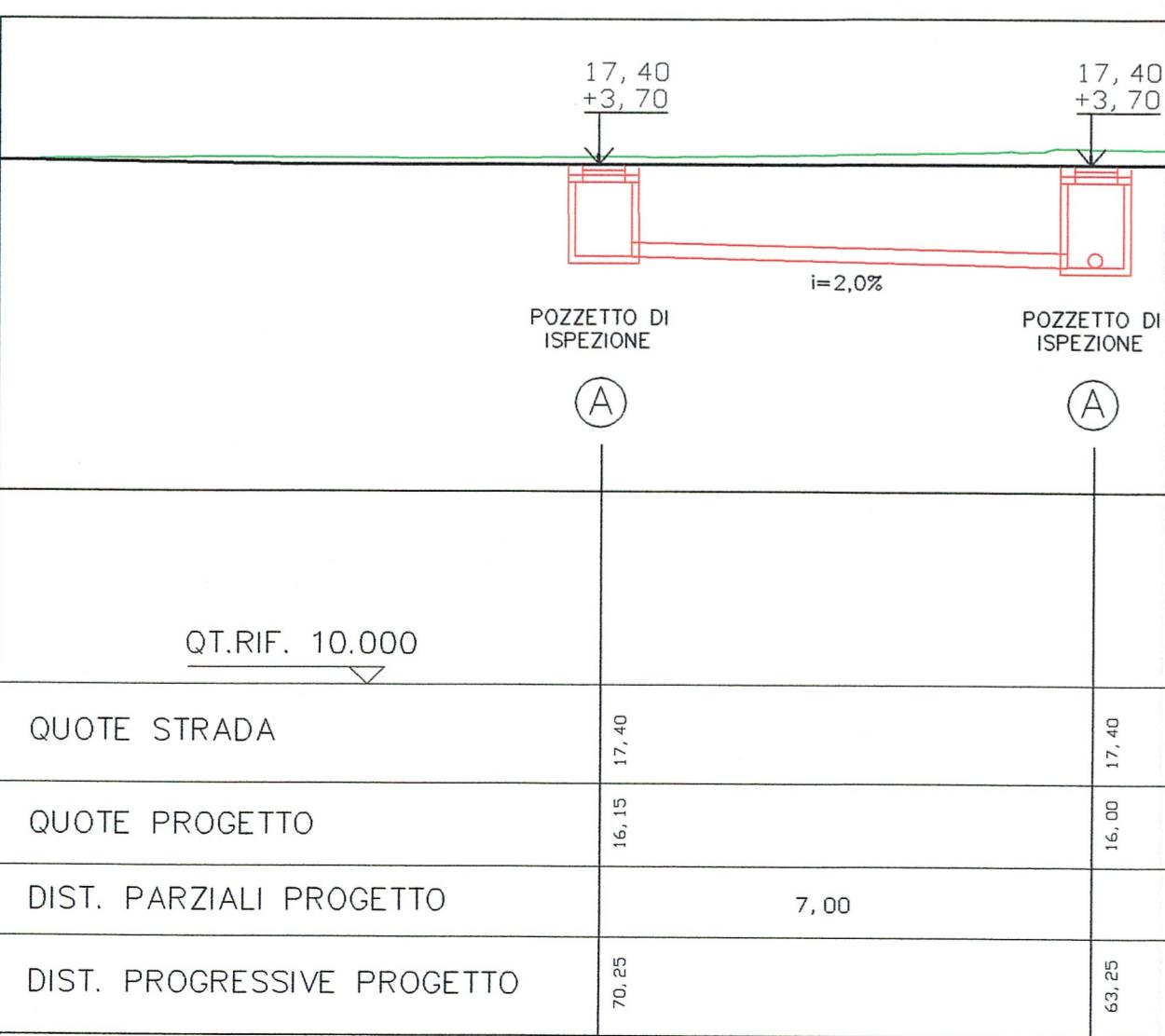
PROFILI LONGITUDINALI (POZZETTI A-A / A-1)
